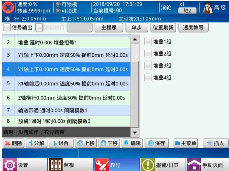
选中要插入的堆叠程序组左边的方框，如选择第2组堆叠，再点击【插入】按钮将该组堆叠插入到程序中，自动运行时，机械手即按照此堆叠程序堆叠排放产品。如果要使用Y轴进行堆叠时，将Y轴下降动作替换为堆叠动作即可。
