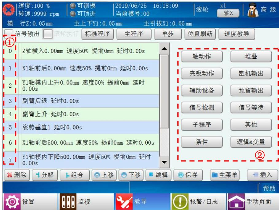
① 步号显示：显示教导程序所在的步号。
