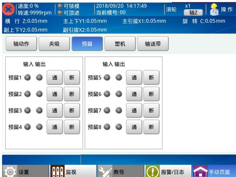
预留动作的手动操作同夹具/吸盘的手动操作一样。
