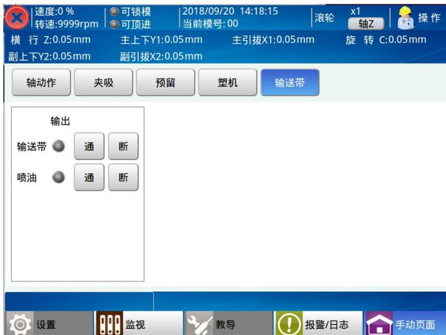
输送带及喷油操作同夹具/吸盘操作。
