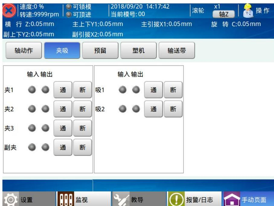
夹具有四组，点击按钮【通】即相应的夹具通动作，点击按钮【断】即相应的夹具断开动作。
