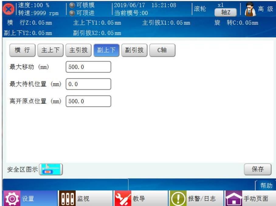
副上下轴的参数设置、安全区图示和主上下轴一样。参考见 5.6.2 节【主上下轴】。
