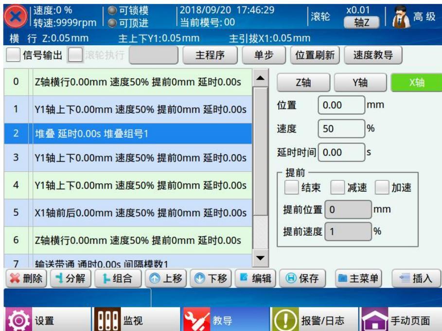
选中要插入的堆叠程序组左边的方框，如选择第 1 组堆叠，再点击“插入”按钮将该组堆叠插入到要开始堆叠的程序步前，自动运行时，机械手即按照此堆叠程序堆叠排放产品。如果要使用 Y 轴进行堆叠时，将 Y 轴下降动作替换为堆叠动作即可。
