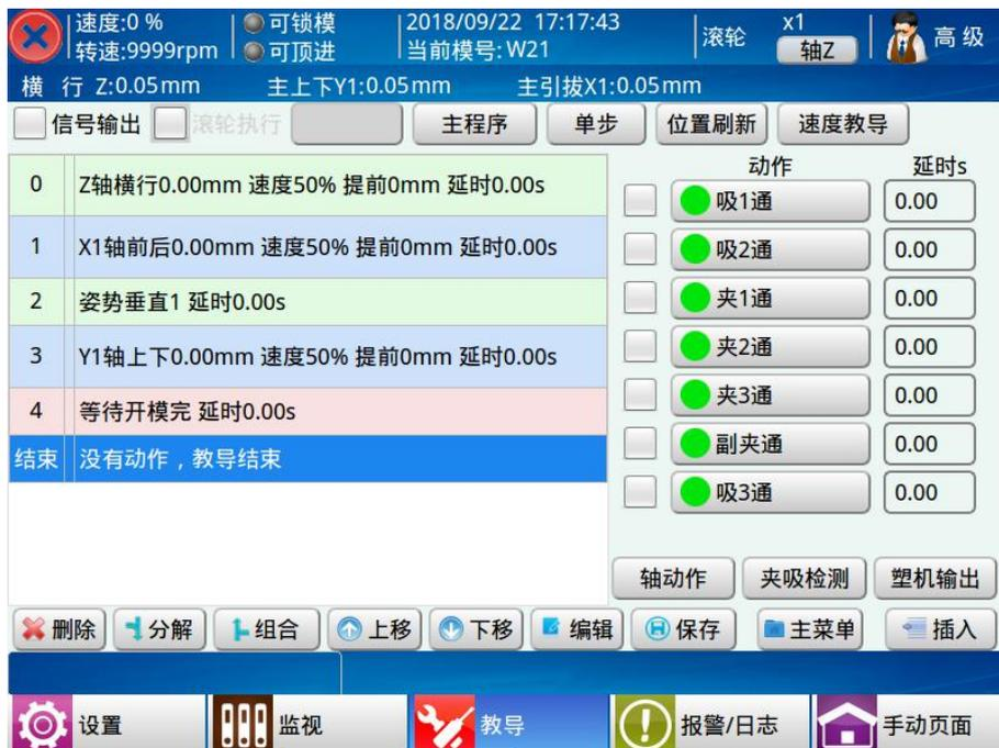
控制器可控制有四组夹具和两组吸盘动作，点击所要控制的夹具或吸盘按钮，该夹具或吸盘即输出同时按钮上的指示灯即变成绿色。再点击左边的使其变成, 再点击【插入】
